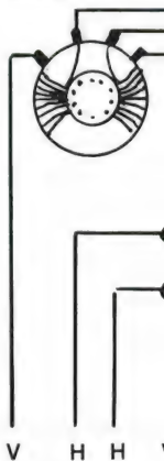
Fig. 4. Door met een schakelaar de signaalbron te schakelen, kan men de horizontale afbuigjuk schakelen met een andere bron.
